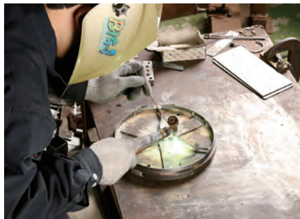
ロウ付け溶接
